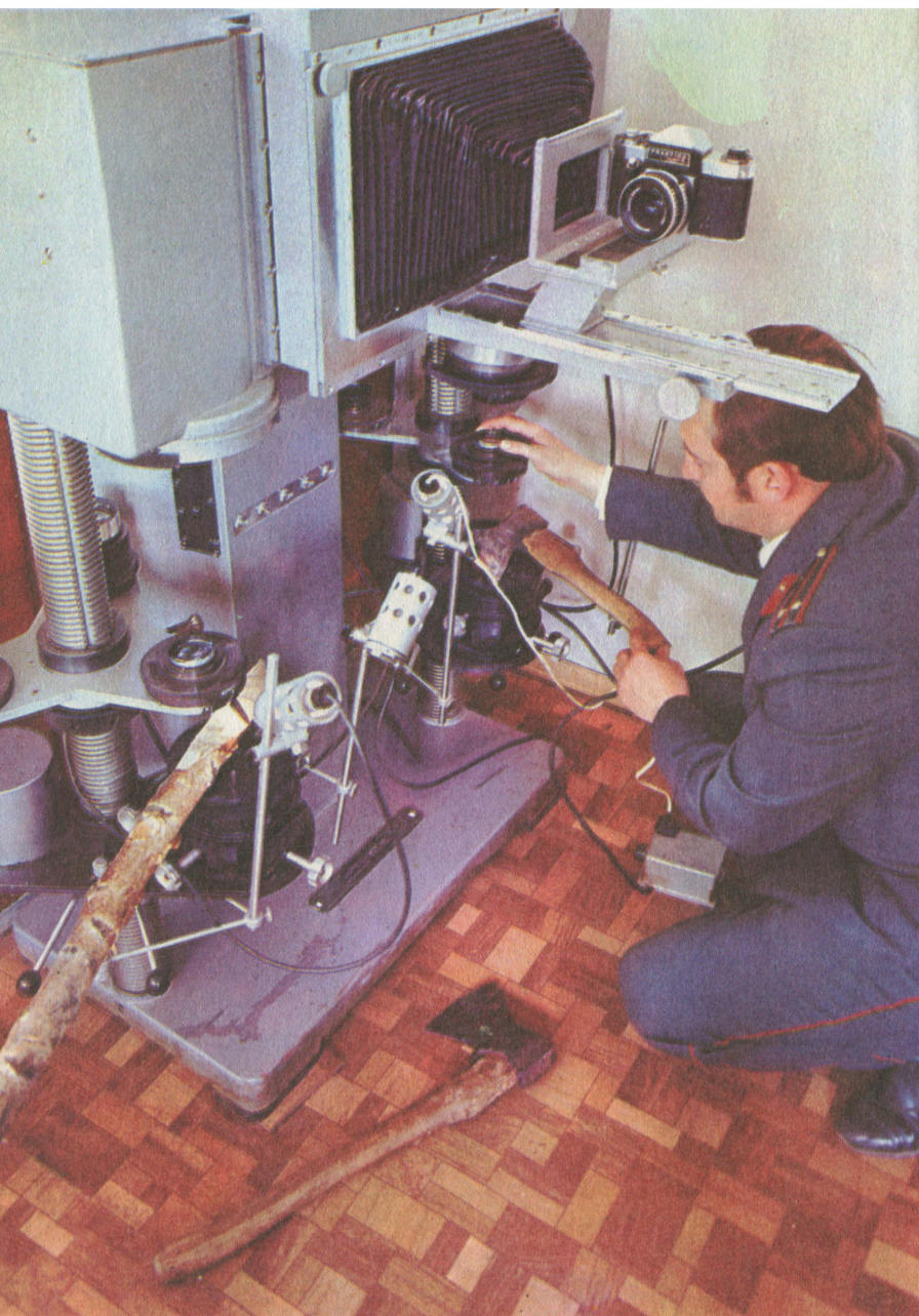
Эксперт криминалистической лаборатории УВД Калужского облисполкома применяет современную аппаратуру для сравнения следов разруба на дереве с лезвием топора.
